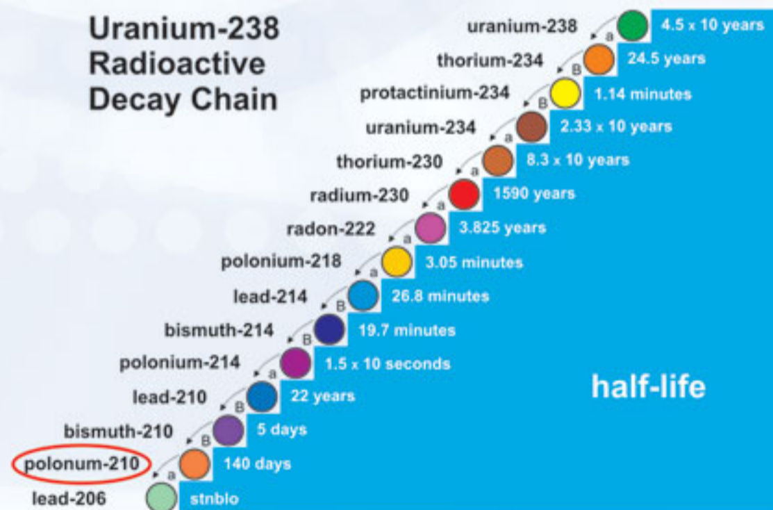
شکل ۲- زنجیره واپاشی اورانیوم و تبدیل آن به Po-210
